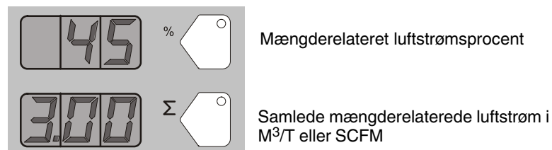
Figur 4-13 Smart Flow funktionen - Mængderelateret luftstrømsprocent eller samlet luftstrøm \Sigma
