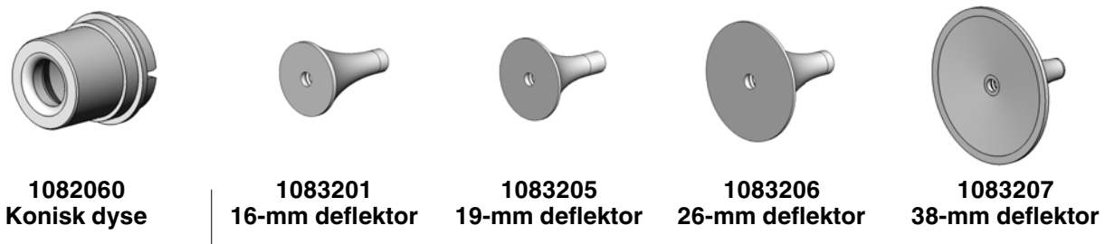
Figur 7-6 Konisk dyse og deflektorer
