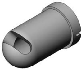
Kuva 7-4 45 asteen suutin kulmaruiskutukseen
