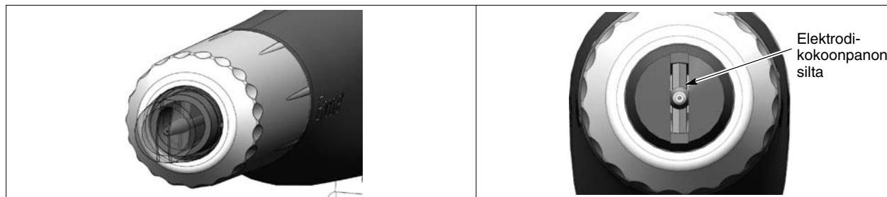
Kuva 4-3 Suuttimen oikea suuntaus
