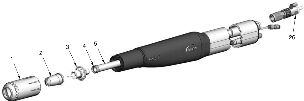
Kuva 7-6 Pulveriradan kuluvien osien vaihtaminen
