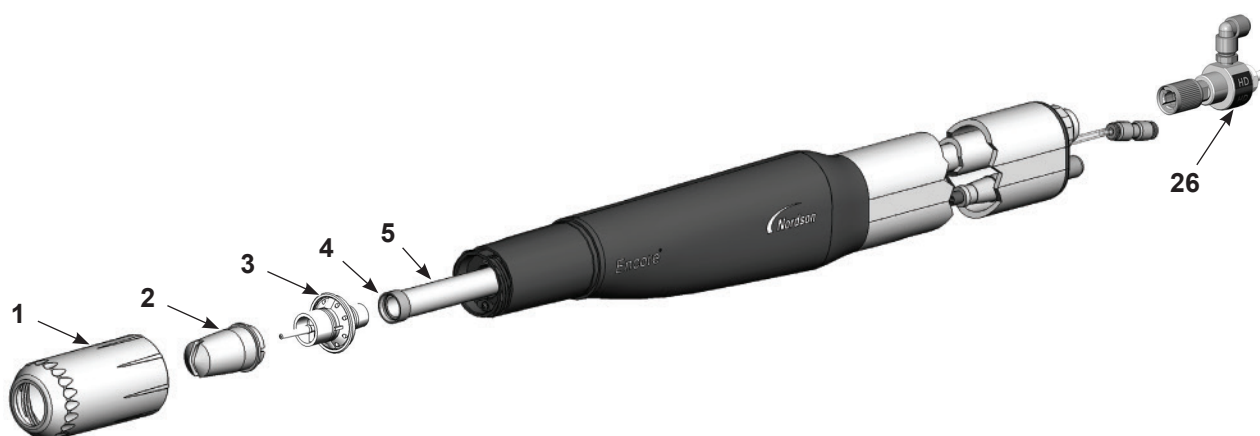
Figura 7-1 Sostituzione di pezzi usurati dalla polvere
