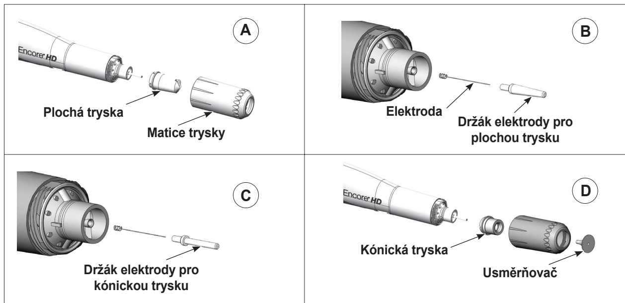
Obrázek 7 Přestavba z ploché stříkácí trysky na kónickou stříkácí trysku
