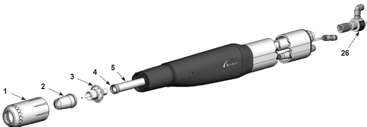
Obrázek 7-1 Výměna dílů opotřebených práškem
