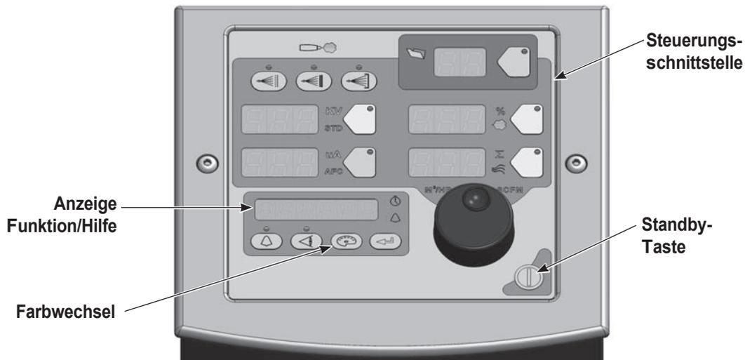
Abbildung 4-1 Systembedienelemente – Abbildung zeigt mobiles System
