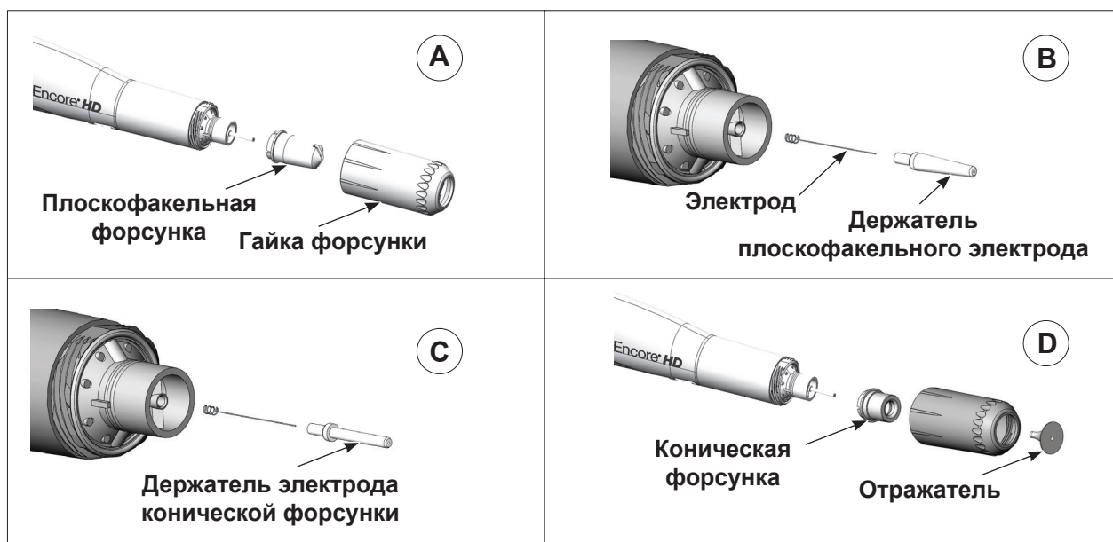
Рис. 7 Модернизация плоскофакельной форсунки до конической
