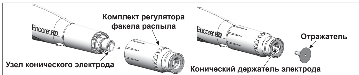
Рис. 9 Монтаж комплекта регулятора факела распыла
