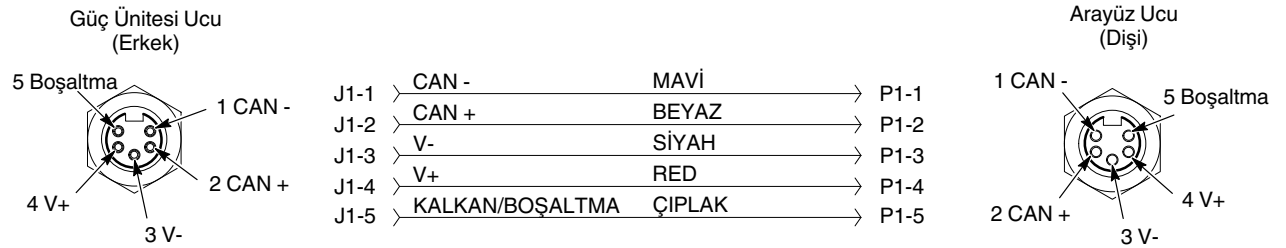
Şekil 5-5 Kumanda Arabağlantı Kablosu Kabloama
