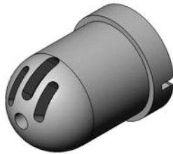
Şekil 7-5 45 Derece Düz Püskürtme Nozulu
