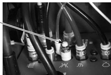
Rysunek 4-4 Lokalizacja zaworu powietrza do czyszczenia elektrody
