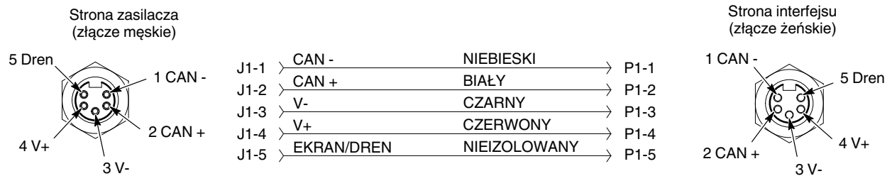
Rysunek 5-5 Test kabli połączeniowych sterownika
