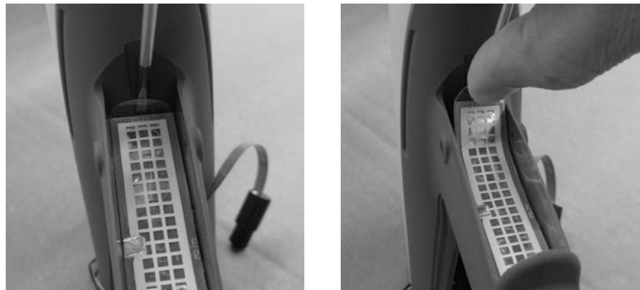
Abb. 6-8 Auslöserschalter vom Griff abnehmen
