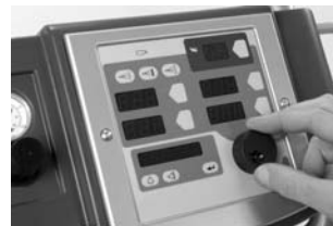
Modification d'un point de consigne
