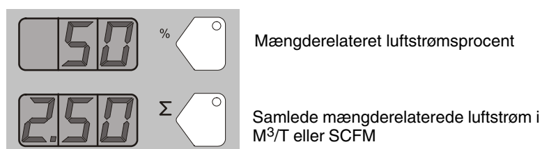
Figur 4-20 Smart Flow funktionen - Mængderelateret luftstrømsprocent eller samlet luftstrøm \Sigma
