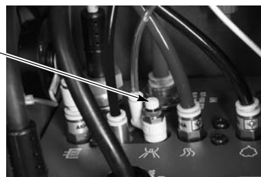
Bild 4-4 Placering av ventil för spolluft för elektrod
