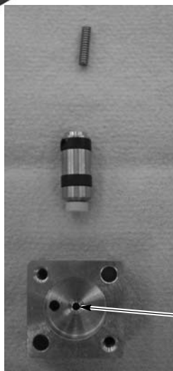
Bild 6-14 Reparation av iFlow modul - Byte av magnetventil och Rengöring eller utbyte av proportionalventil
