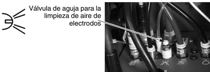
Figura 4-4 Localización de la válvula para la limpieza de aire de electrodos
