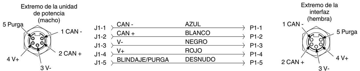
Figura 5-5 Conexión eléctrica del cable de interconexión del controlador
