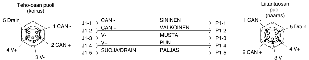
Kuva 5-5 Ohjausyksikön välikaapelin testaus
