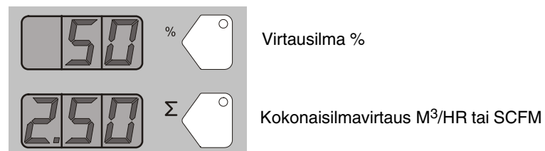
Kuva 4-20 Smart Flow -tila - virtausilman % tai kokonaisvirtaus \Sigma
