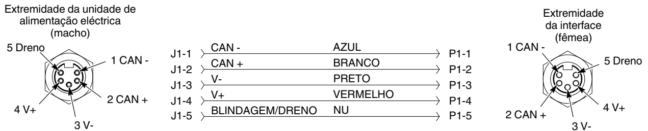
Figura 5-5 Ligações eléctricas do cabo de interligação do controlador
