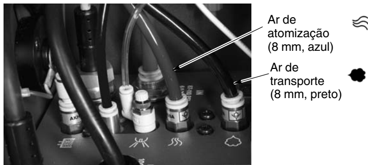
Figura 3-10 Ligações de tubos de ar de transporte e de atomização à unidade de alimentação eléctrica
