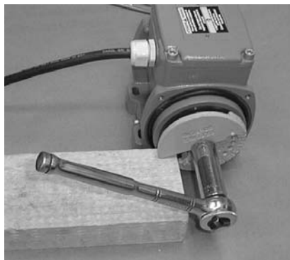
Figura 2 Ajuste de los pesos del motor de la cribadora
