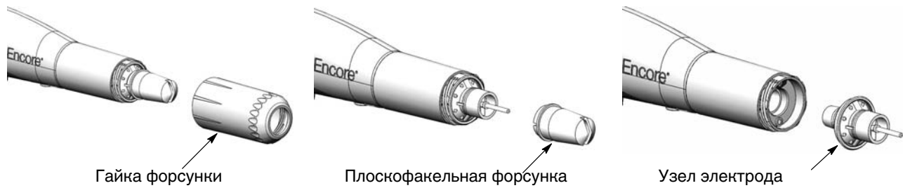
Рис. 4-6 Замена плоскофакельных форсунок
