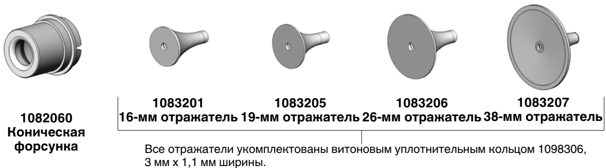
Рис. 9-6 Конические форсунки и отражатели
