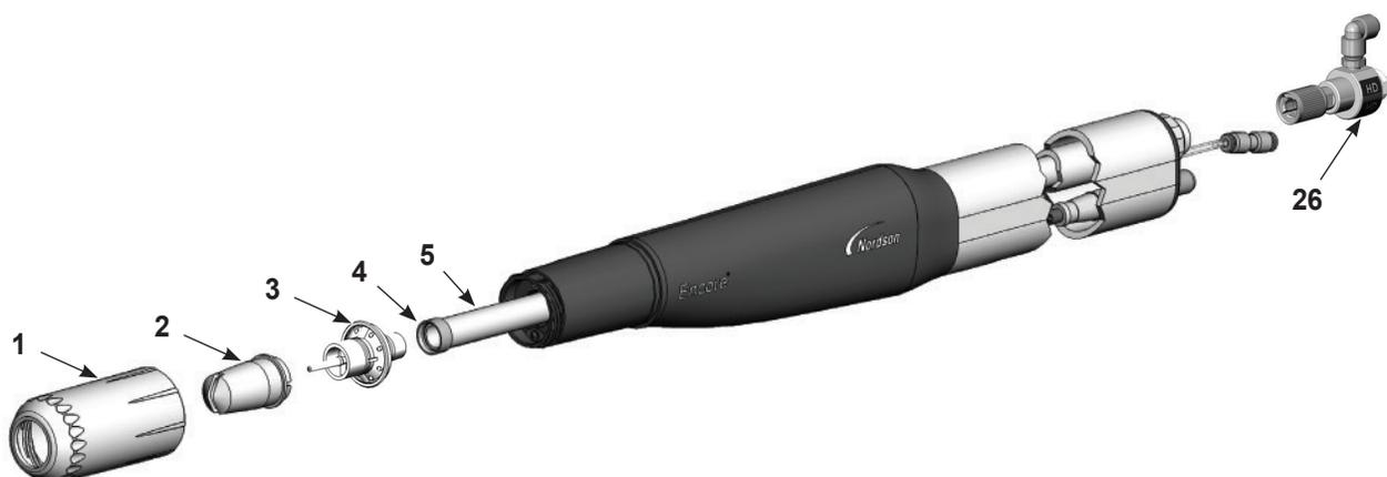
Abbildung 7-1 Verschleißteile der Pulverführung ersetzen
