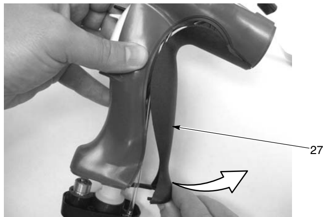
Paveikslėlis 5-7 Įžeminimo įdėklo nuėmimas
