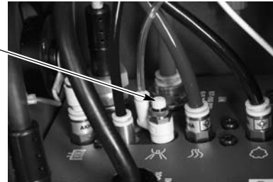
Paveikslėlis 3-3 Elektrodo oro plovimo vožtuvo vieta
