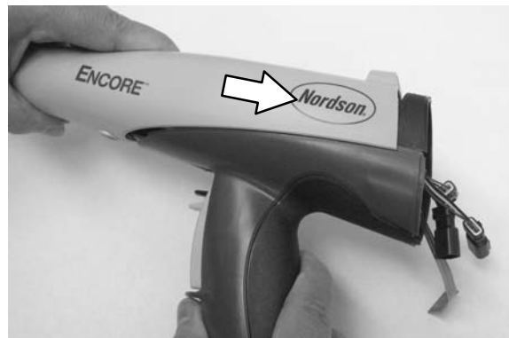
Paveikslėlis 5-14 Išleidimo miltelių vamzdelio montavimas
