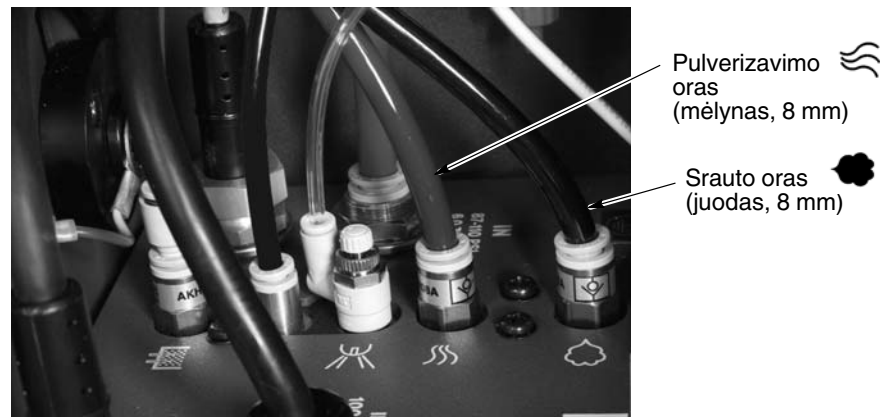
Paveikslėlis 2-9 Srauto ir pulverizavimo oro vamzdelių prijungimas prie maitinimo bloko
