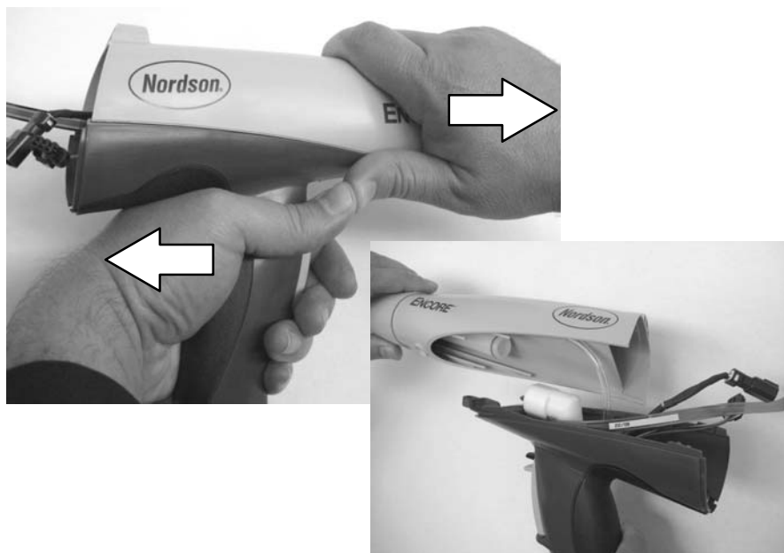
Paveikslėlis 5-5 Rankenos ir purkštuvu korpuso atskyrimas
