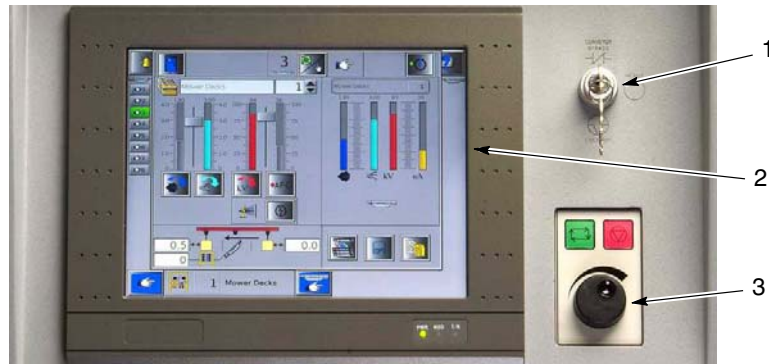
Figura 2-3 Panel frontal de la consola maestra
