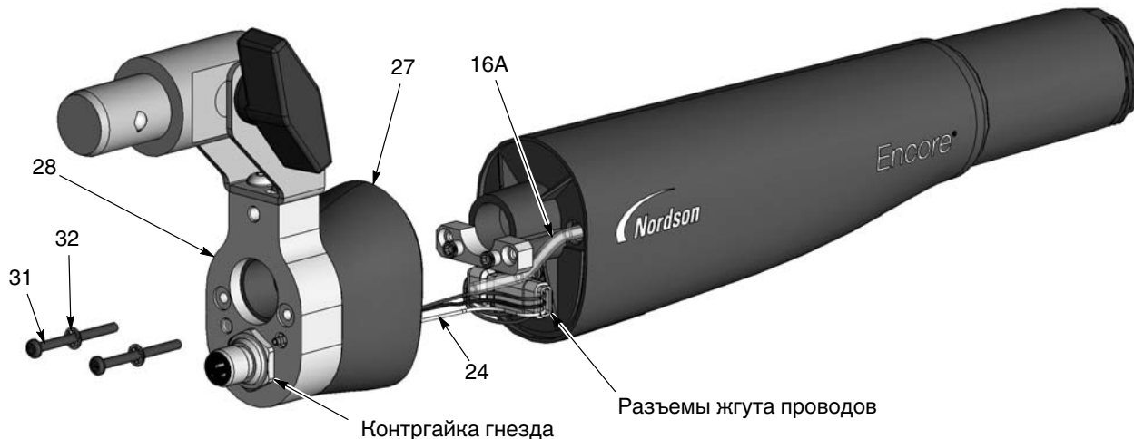
Рис. 14 Разборка распылителя – замена порошковой трубки
