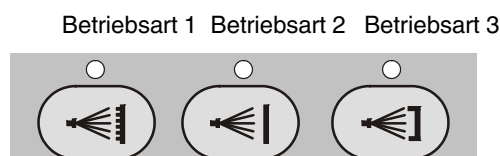
Abb. 4-14 Betriebsart Select Charge
