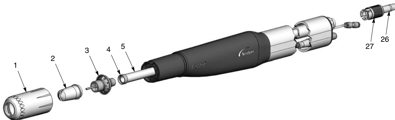
Figur 16 Udskiftning af pulverliddele
