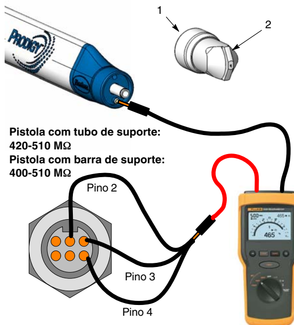
Figura 15 Teste do multiplicador/resistência
