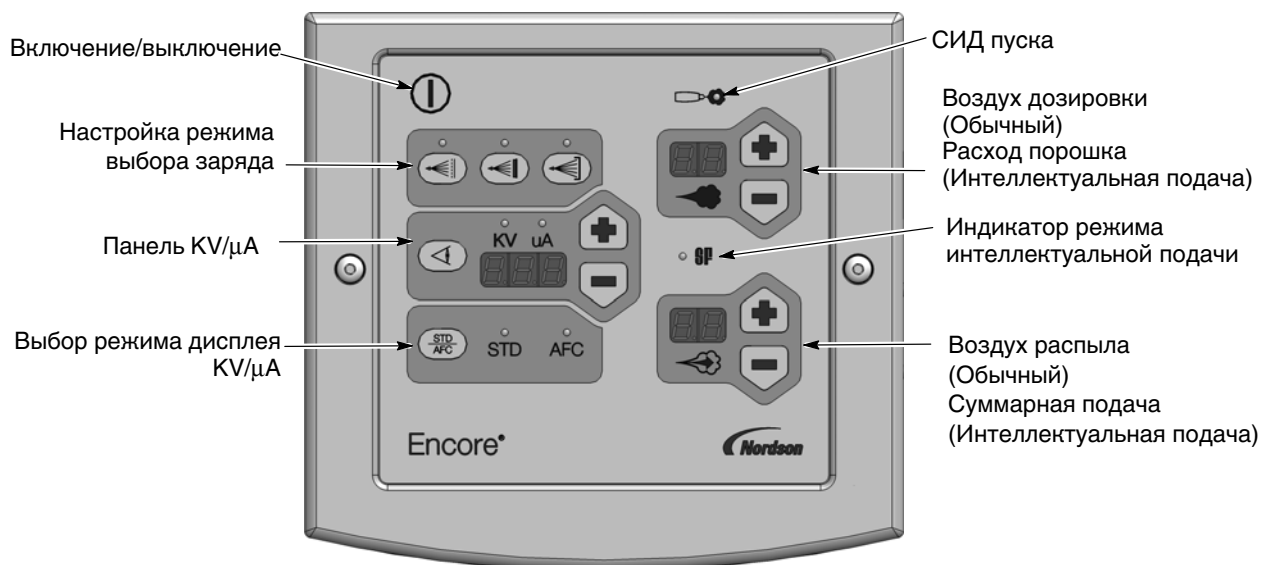
Рис. 4-1 Интерфейс блока управления распылителями
