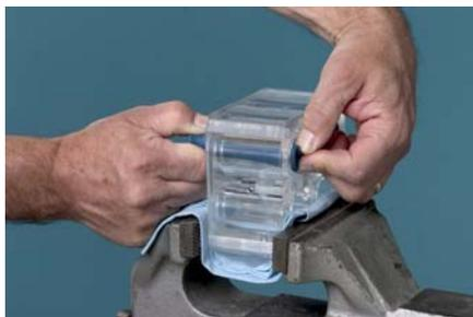
Utiliser l'autre main pour pincer la bride à l'extrémité opposée de la valve à étranglement.
