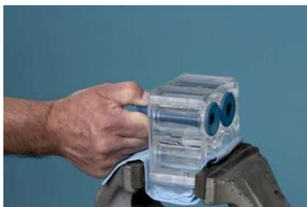
Placer le corps de la valve à étranglement dans un étau muni d'une garniture avec le dessous dirigé vers vous. Saisir et tirer l'extrémité inférieure de la valve à étranglement d'une main.
