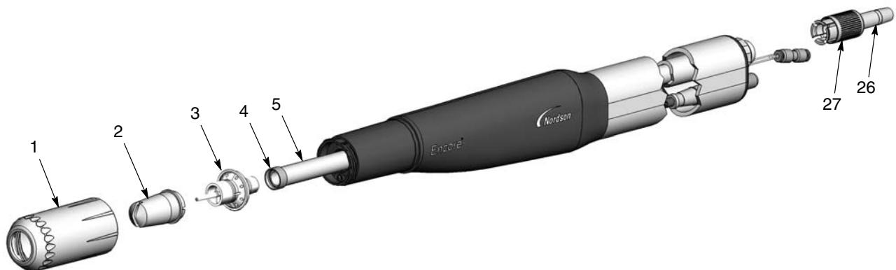
Figura 16 Sostituzione di pezzi usurati dalla polvere
