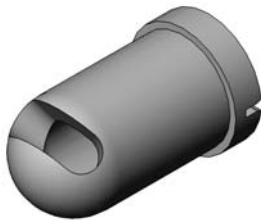
Figura 30 Ugello per spruzzo angolato a 45 gradi
