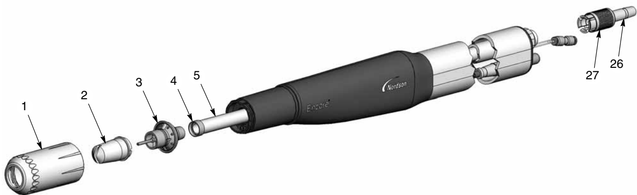
Afbeelding 15 Versleten onderdelen in poederkanaal vervangen
