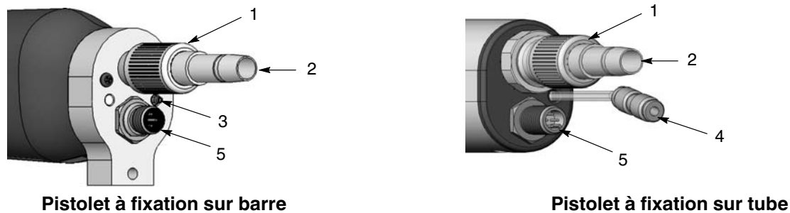
Figure 5 Raccordements du pistolet – Pistolets à fixation sur barre et sur tube
