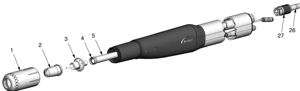
Figure 16 Remplacement des pièces d'usure en contact avec la poudre
