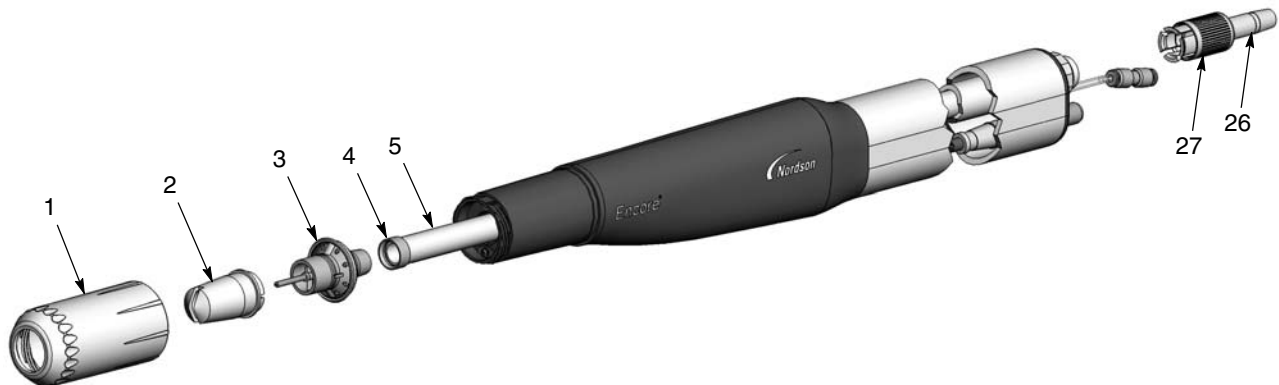
Figura 15 Substituição de peças gastas pelo pó
