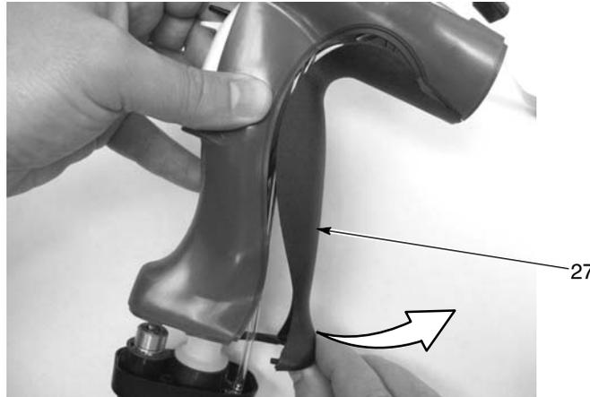
Figura 5-7 Remoção do contacto de terra
