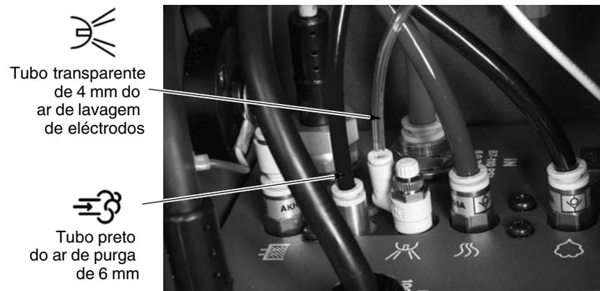
Figura 2-11 Ligação dos tubos de ar à unidade de alimentação eléctrica
