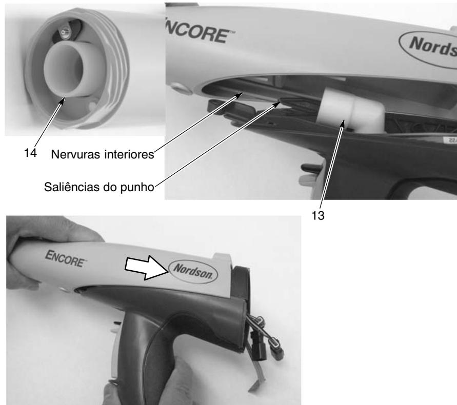
Figura 5-14 Montagem do tubo de saída de pó
