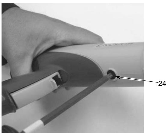
Figura 5-4 Remoção do parafuso do corpo da pistola
