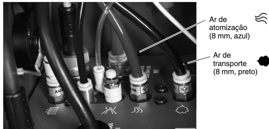
Figura 2-9 Ligações de tubos de ar de transporte e de atomização à unidade de alimentação eléctrica
