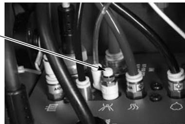
Figura 3-3 Localização da válvula do ar de lavagem do eléctrodo
