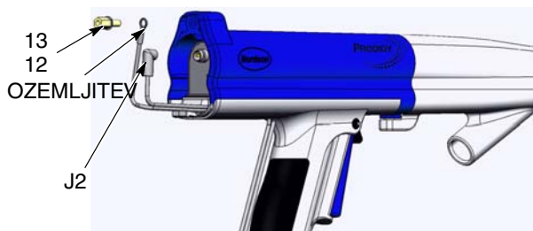
Slika 21 Odklapljanje krmilnega kabla
