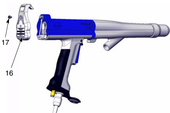
Slika 20 Odstranjevanje končnega pokrova
