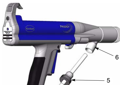
Slika 18 Odstranjevanje gumba za zaklepanje in cevi za prah
