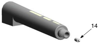
Slika 28 Odstranjevanje kontaktne podložke
