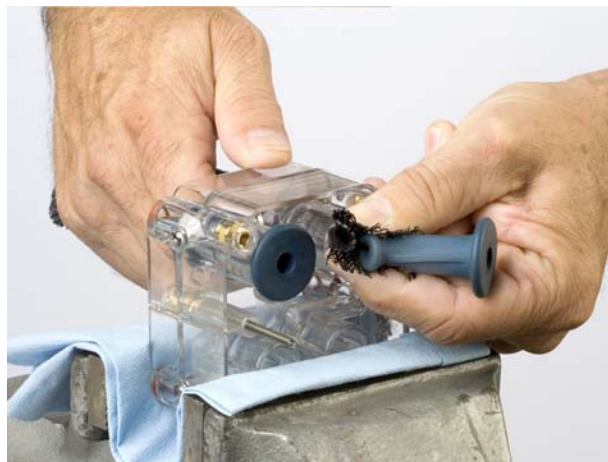
Slika 14 Stiskanje prirobnice z oznako UP ščipalnega ventila
