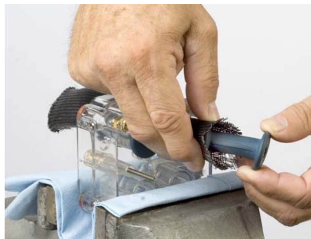
Slika 13 Vstavljanje ščipalnega ventila v orodje za vstavljanje
