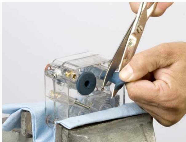
Slika 12 Odstranjevanje ščipalnega ventila
