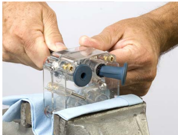
Slika 15 Vlečenje ščipalnega ventila v ohišje ventila
