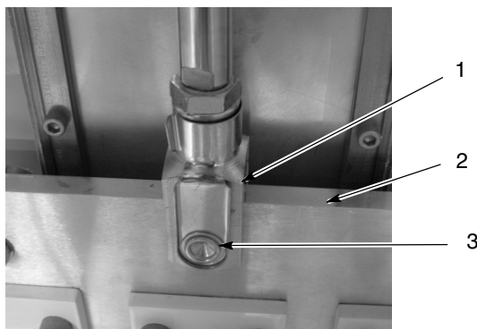
Rys. 8-7 Sworzeń mocujący jarzmo siłownika do podnoszenia
