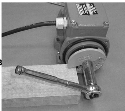
Rys. 8-16 Regulacja obciążenia silnika wibracyjnego
