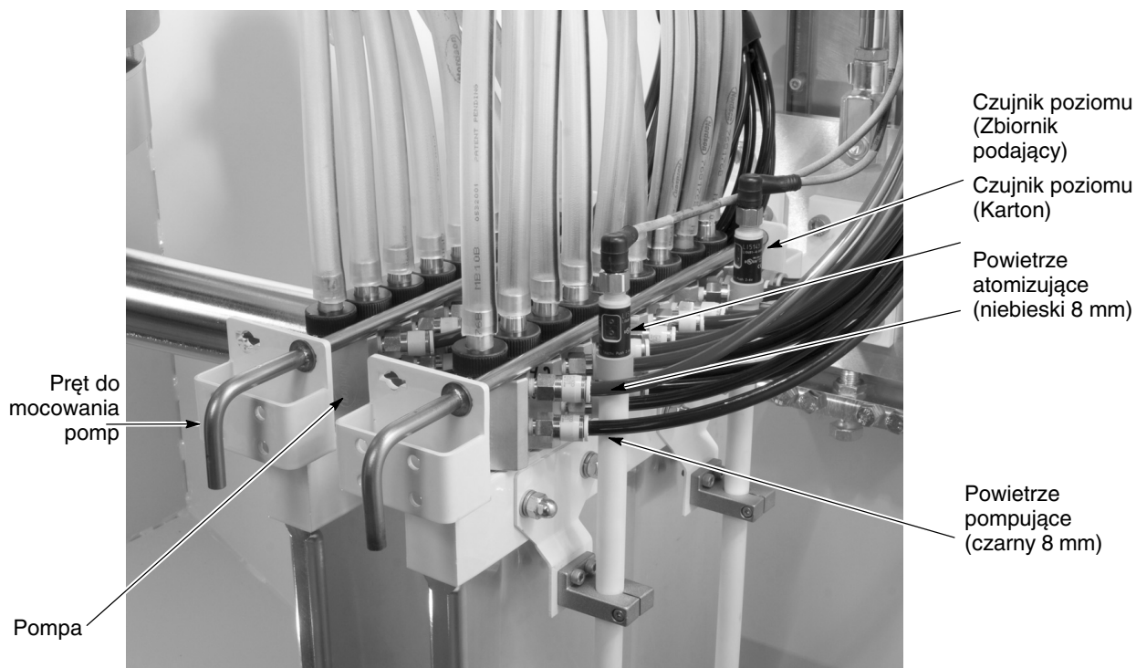
Rys. 3-4 Instalacja pompy, węży pneumatycznych i proszkowych
