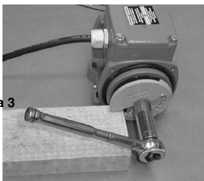
Figura 8-15 Reglarea greutateii vibratorului
