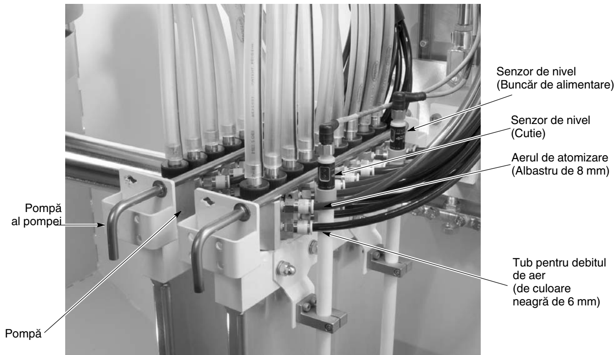
Figura 3-4 Instalarea pompei, a tubulaturii de aer și a furtunului de alimentare cu pulbere
