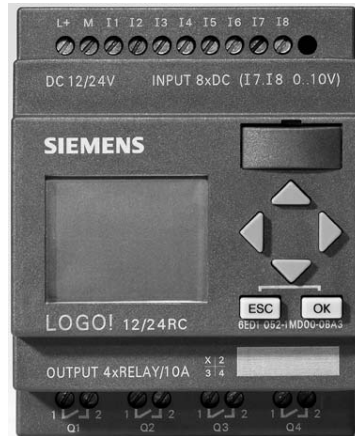
Figura 4-10 Interfața centrului de alimentare PLC
