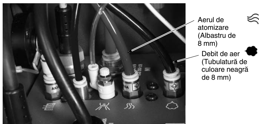
Figura 2-9 Conexiuni ale tubulaturii de aer și aer de atomizare la unitatea de curent
