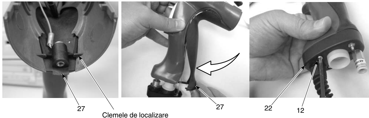
Figura 5-12 Asamblarea suportului de împământare și a bazei pe mâner
