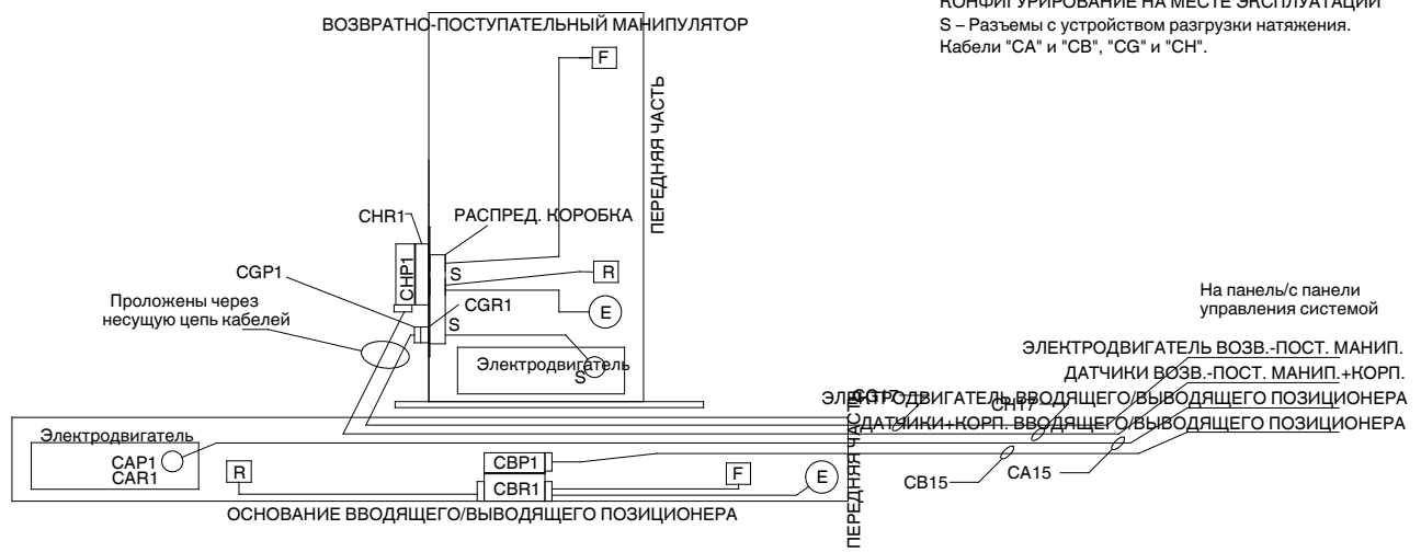
Рис. 10 Соединение кабелей – позиционер и возвратно-поступательный манипулятор Nordson – европейские системы
