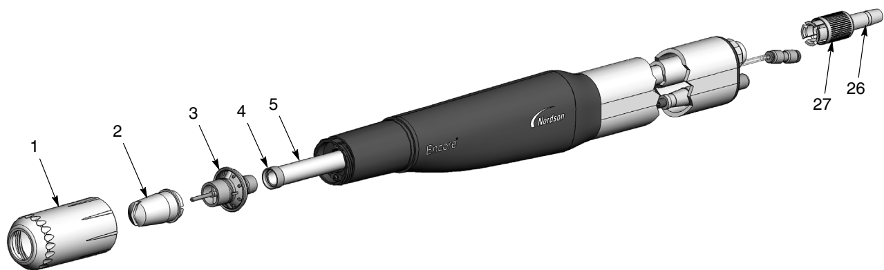
Figura 15 Sustitución de piezas de desgaste de polvo
