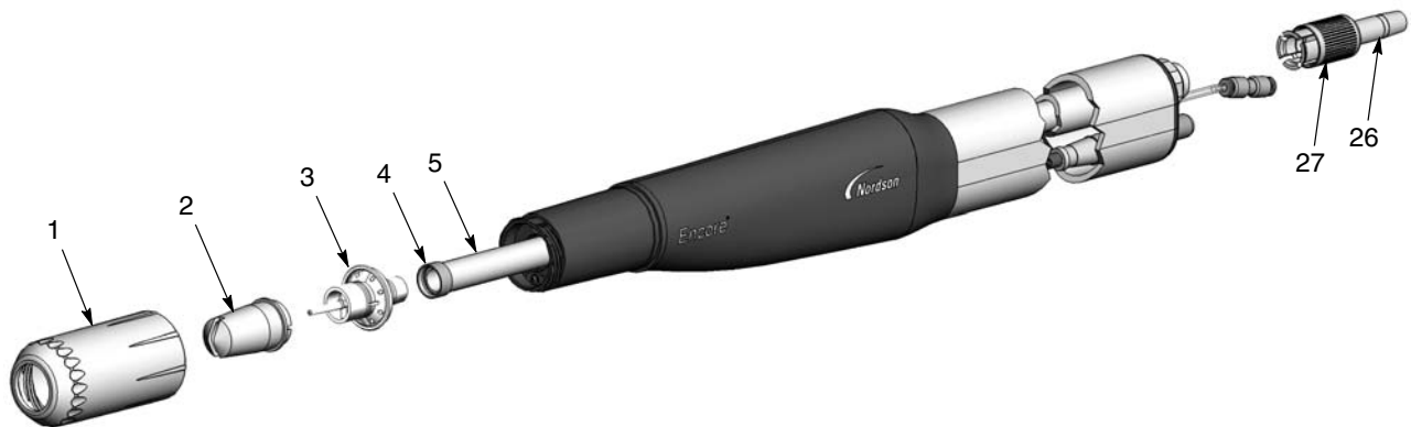
Figura 16 Sustitución de piezas de desgaste de polvo
