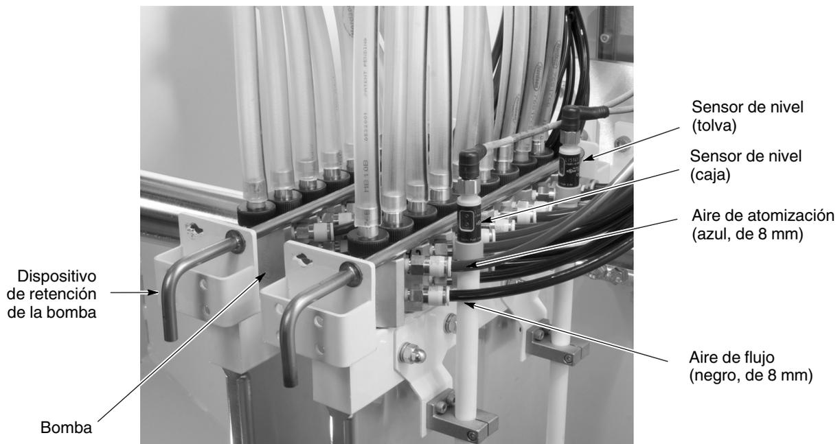
Figura 3-4 Bomba, tubo de aire, e instalación de las mangueras de alimentación de polvo
