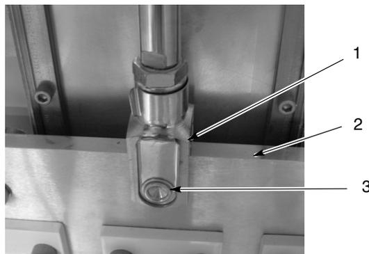
Figura 8-6 Pasador de horquilla del cilindro de elevación
