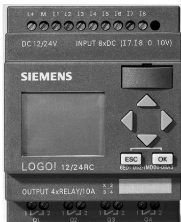
Figura 4-1 Interface do CLP do centro de alimentação
