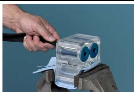
Suspaudžiamovožtuvu įkišimo įrankį stipriai traukite, kol suspaudžiamovožtuvu galą su žodžiu „UP“ ir visą įkišimo įrankį ištirausite iš suspaudžiamujų vožtuvų korpuso viršaus.
