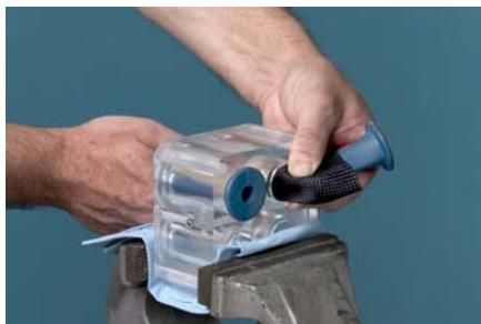
Suspaudžiamovožtuvu galą su žodžiu „UP“ įkiškite į suspaudžiamomojo vožtuvu įkišimo įrankį.
