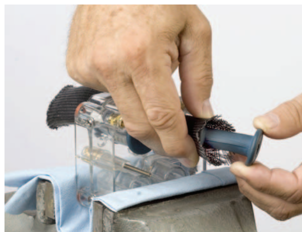
Paveikslėlis 13 Suspaužiamojo vožtuvo įkišimas į įkišimo įrankį
