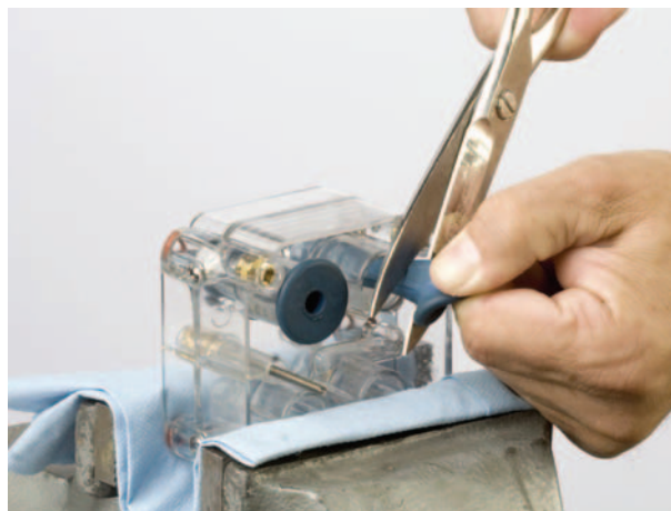
Paveikslėlis 12 Suspaužiamųjų vožtuvų išėmimas
