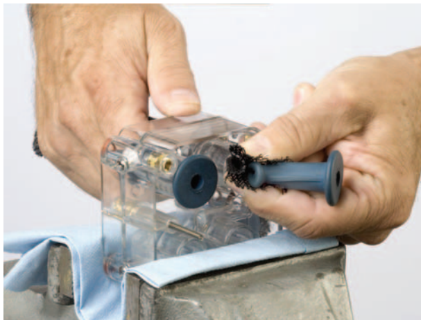
Paveikslėlis 14 Suspaudžiamojo vožtuvo antbriaunio su žodžiu „UP“ suspaudimas plokščiai
