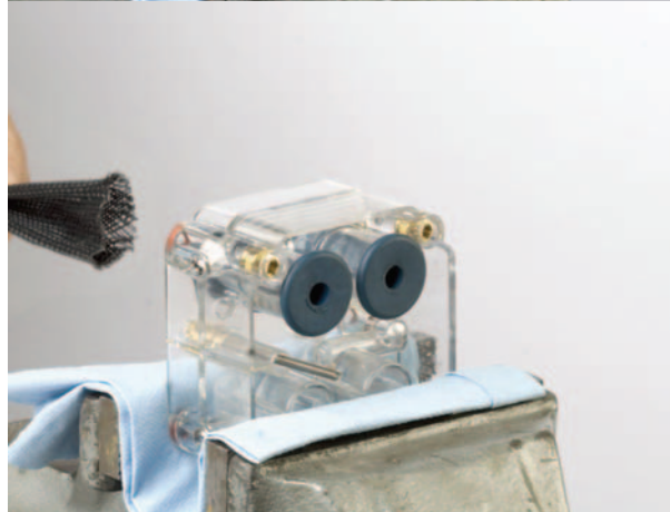
Paveikslėlis 16 Suspaudžiamojo vožtuvo traukimas pro vožtuvų korpus
