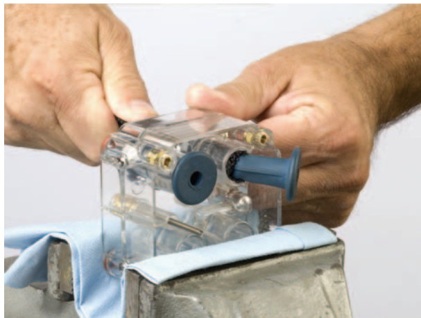
Paveikslėlis 15 Suspaudžiamojo vožtuvo traukimas į vožtuvų korpus
