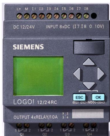
Paveikslėlis 10 Tiekimo centro PLC tipo reguliatorius
