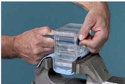
Пальцами другой руки сдвинуть фланец пережимного клапана с противоположной стороны.
