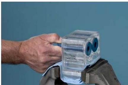
Зажать корпус пережимных клапанов нижним концом к себе в тисках с прокладками на губках. Зажать и оттянуть нижнюю часть пережимного клапана одной рукой.
