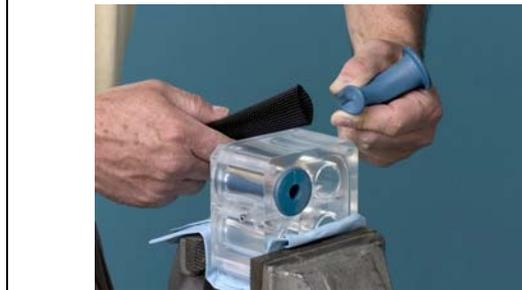
**ПРИМЕЧАНИЕ:** Вставив пережимной клапан в монтажный инструмент, сдавить до плоского состояния верхний (UP) фланец клапана.
