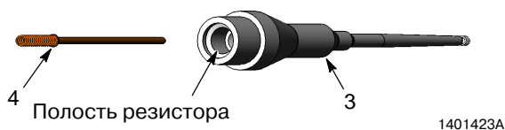
Рис. 6 Извлечение резистора из держателя
